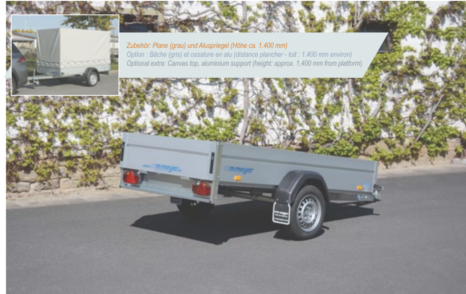
HZ 7525/126 Achse und V-Deichsel verzinkt, Gummifederachse, Alubordwände eloxiert mit Sicke zur Planenbefestigung HZ 7525/126 Essieu et timon en V galvanisés, essieu à suspension en caoutchouc, ridelles en aluminium anodisé avec rainure pour attacher une bâche HZ 7525/126 Galvanised axle and V drawbar, rubber torsion axle, anodised aluminium side panels with seam to fasten canvas top
