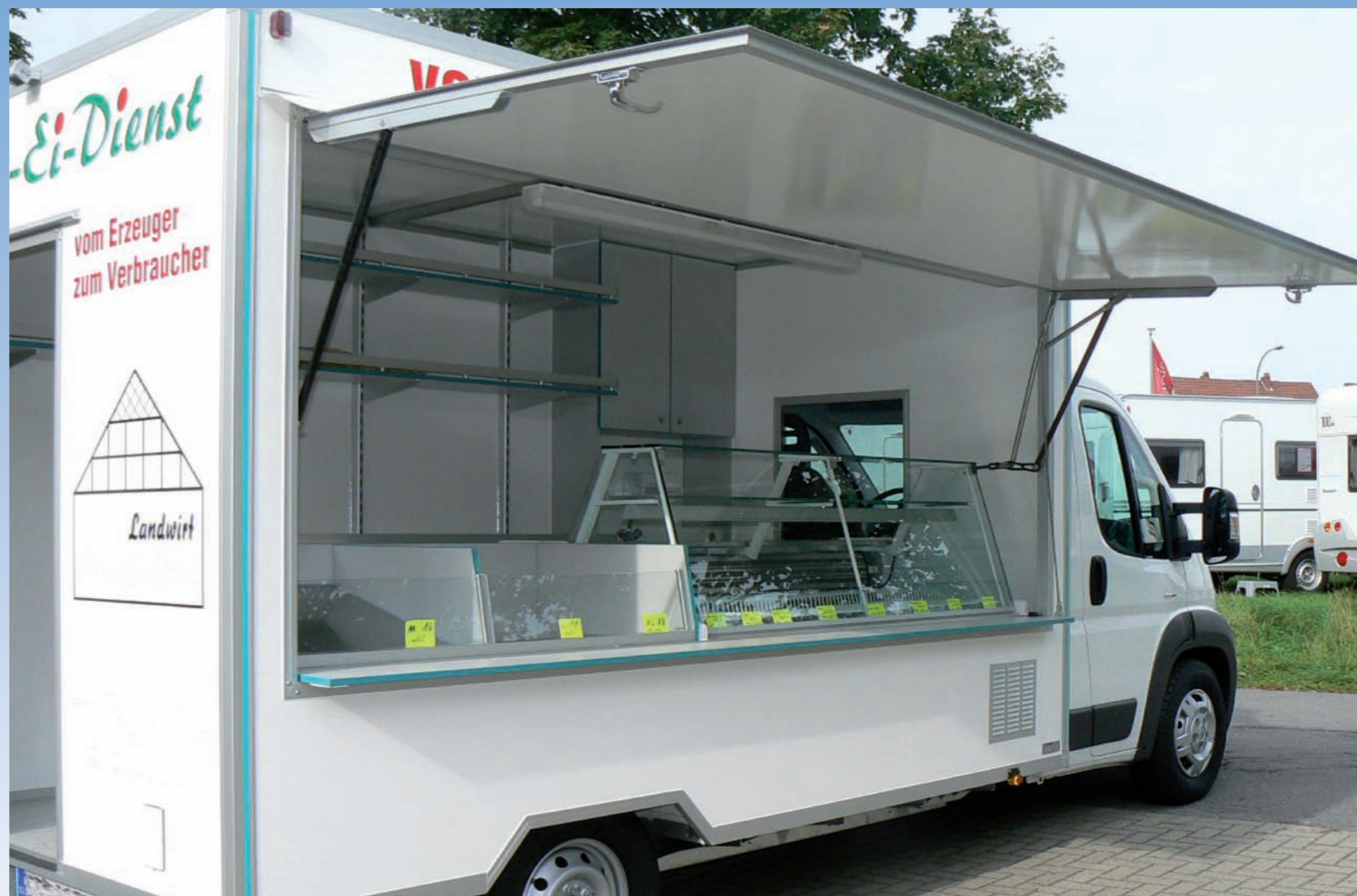
VMA 500 Verkaufsmobil aufbau mit Tiefrahmenfahrgestell, Kühltheke und Durchgangstür zur Fahrerkabine VMA 500 Véhicule de vente avec châssis bas, vitrine frigorifique et porte entre carrosserie et cabine du chauffeur VMA 500 Vending van with low chassis, cooler cabinet and door between box und driver's cabin
