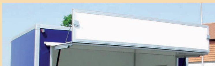
Reklameschild klappbar (hier: Teil der Verkaufsklappe) Panneau publicitaire (ici : fait partie du clapet de vente) Adjustable advertisement support (here: part of vending hatch)
