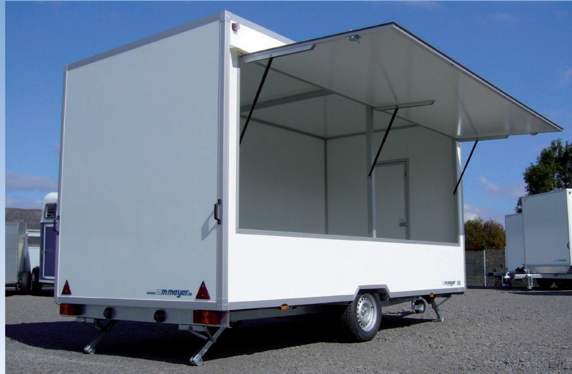
VK 1545/220 Profi Serienmäßig ab 4.500 mm Länge: Mittel- und Dachstrebe, Verkaufsklappe mit 3 Gasdruckfedern VK 1545/220 Profi En série à partir d'une longueur de 4.500 mm : support central et pour toit, clapet avec 3 amortisseurs VK 1545/220 Profi Standard features in all trailers which are 4,500 mm long or longer: central and roof supports, vending hatch with 3 struts
