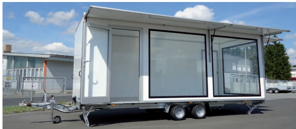
VKHL 2660/220 Profi Sonder Ausstellungsanhänger; Zubehör: höhenverstellbare Deichsel, Türen, Fenster, Klappen VK 2660/220 Profi Spéciale Remorque-exposition ; options : timon réglable en hauteur, portes, fenêtres, clapets VK 2660/220 Profi Special Exhibition trailer; optional extras: drawbar adjustable in height, doors, windows, hatches
