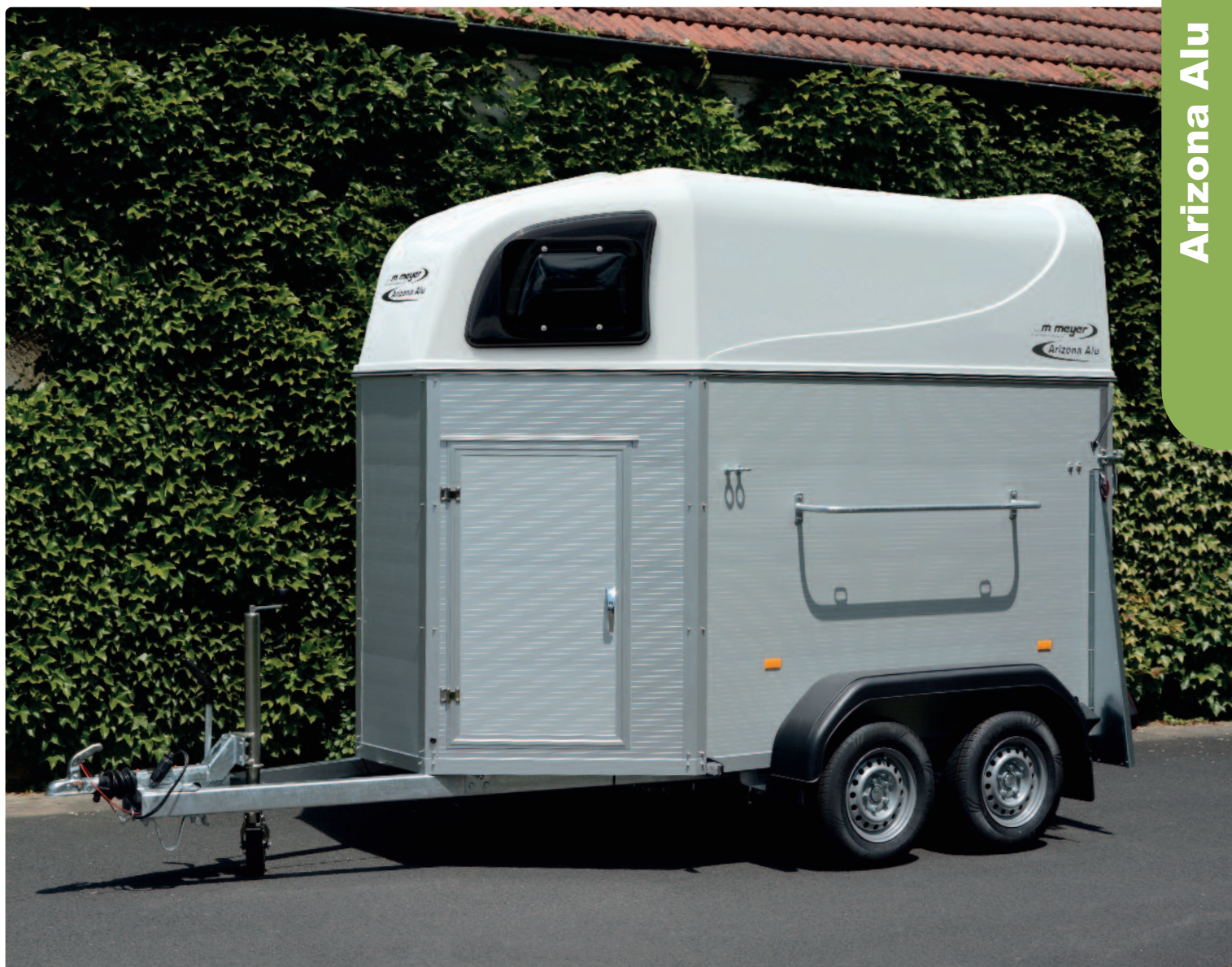
Stützrad verstärkt (klappbar), Aluminiumwände, Polyesterhaube (weiß), Zubehör: Sattelkammer Standard, Sattelablagegestange Roue jockey renforcée (automatique), panneaux en aluminium, hardtop en polyester (blanc), options : sellerie Standard, avec barre d'attache Reinforced jockey wheel (automatic), aluminium side panels, polyester hardtop (white), optional extras: Standard saddle chamber, exterior saddle bar
