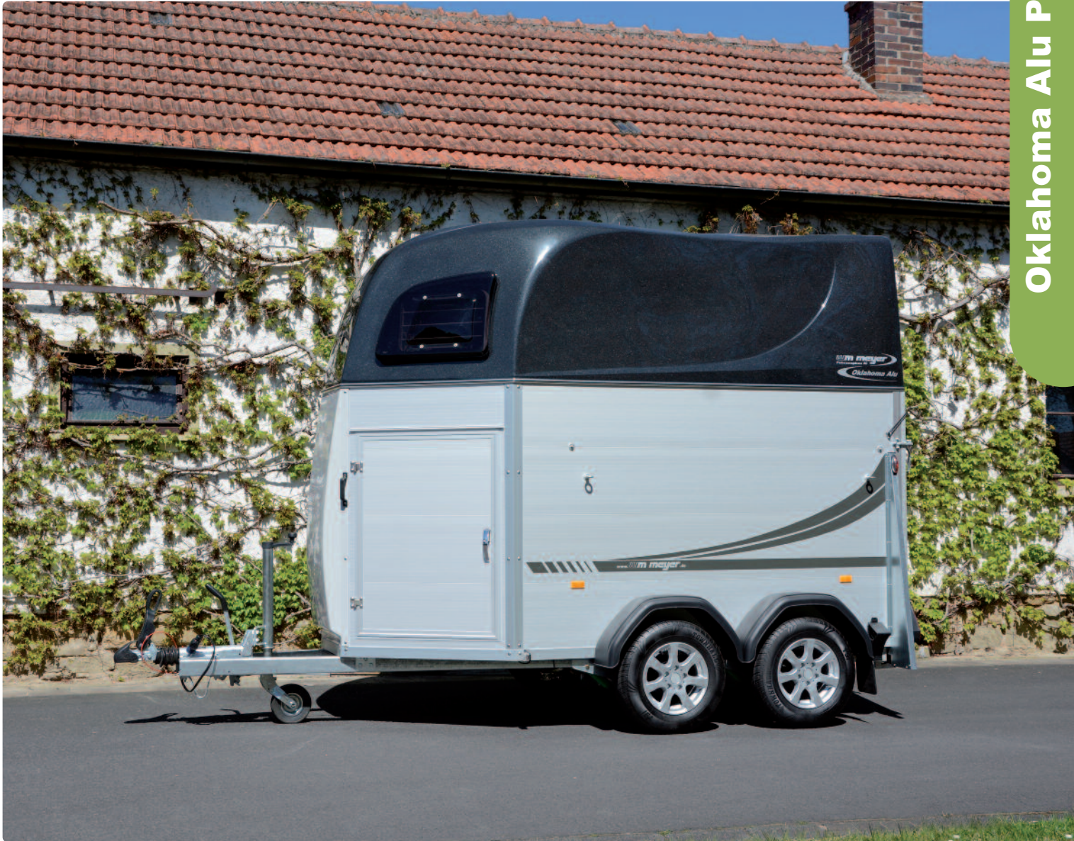
Stützrad verstärkt (klappbar), Aluminiumwände, Sattelkammer Groß, Polyesterhaube (schwarzmetallisch), Zubehör: Antischlingerkupplung Roue jockey renforcée (automatique), panneaux en aluminium, Grande sellerie, hardtop en polyester (noir métallisé), option : stabilisateur de sécurité Reinforced jockey wheel (automatic), aluminium side panels, Grand saddle chamber, polyester hardtop (black metallic), optional extra: anti-sway coupling
