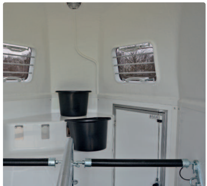
Zubehör: Sattelkammer Groß mit 2 aushängbaren Futterkübeln Option : Grande sellerie avec 2 seaux mangeoire enlevables Optional extra: Grand saddle chamber with 2 removable feed buckets
