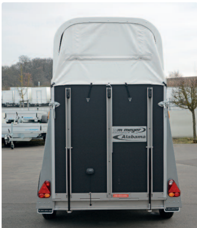
Alabama Basic Planenrollo mit Zugschnur Alabama Basic Bâche arrière automatique avec cordon Alabama Basic Automatic canvas blind with cord
