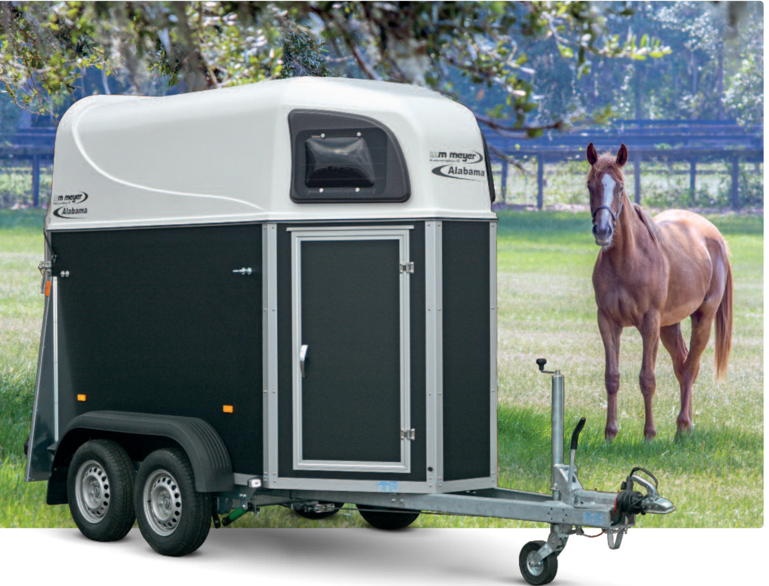
Alabama Basic Stützrad verstärkt (klappbar, mittig), Holzwände (außen: schwarz, innen: weiß), Polyesterhaube (weiß), Zubehör: 100-km/h-Ausführung Alabama Basic Roue jockey renf. (autom., au milieu du timon), panneaux bois (ext. : noir, int. : blanc), hardtop polyester (blanc), opt. : rouler plus confortablement Alabama Basic Reinf. jockey wheel (autom., middle of the drawbar), wooden side panels (ext.: black, int.: white), polyester hardtop (white), opt: smooth-ride kit
