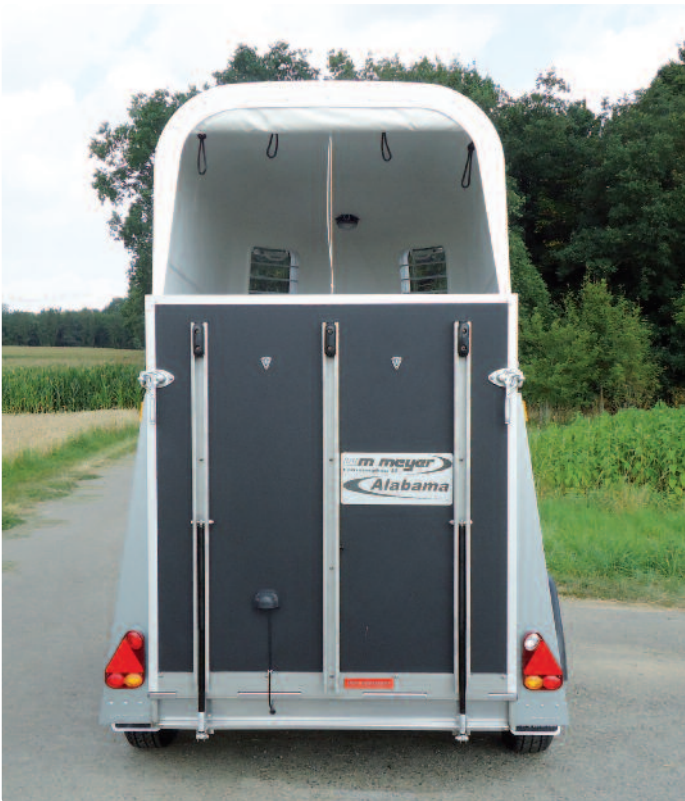
Heckrahmen, Rampenschamier und -träger Edelstahl Bâti arrière, charnières de pont et supports en inox Rear frame, ramp hinge and ramp supports made of stainless steel
