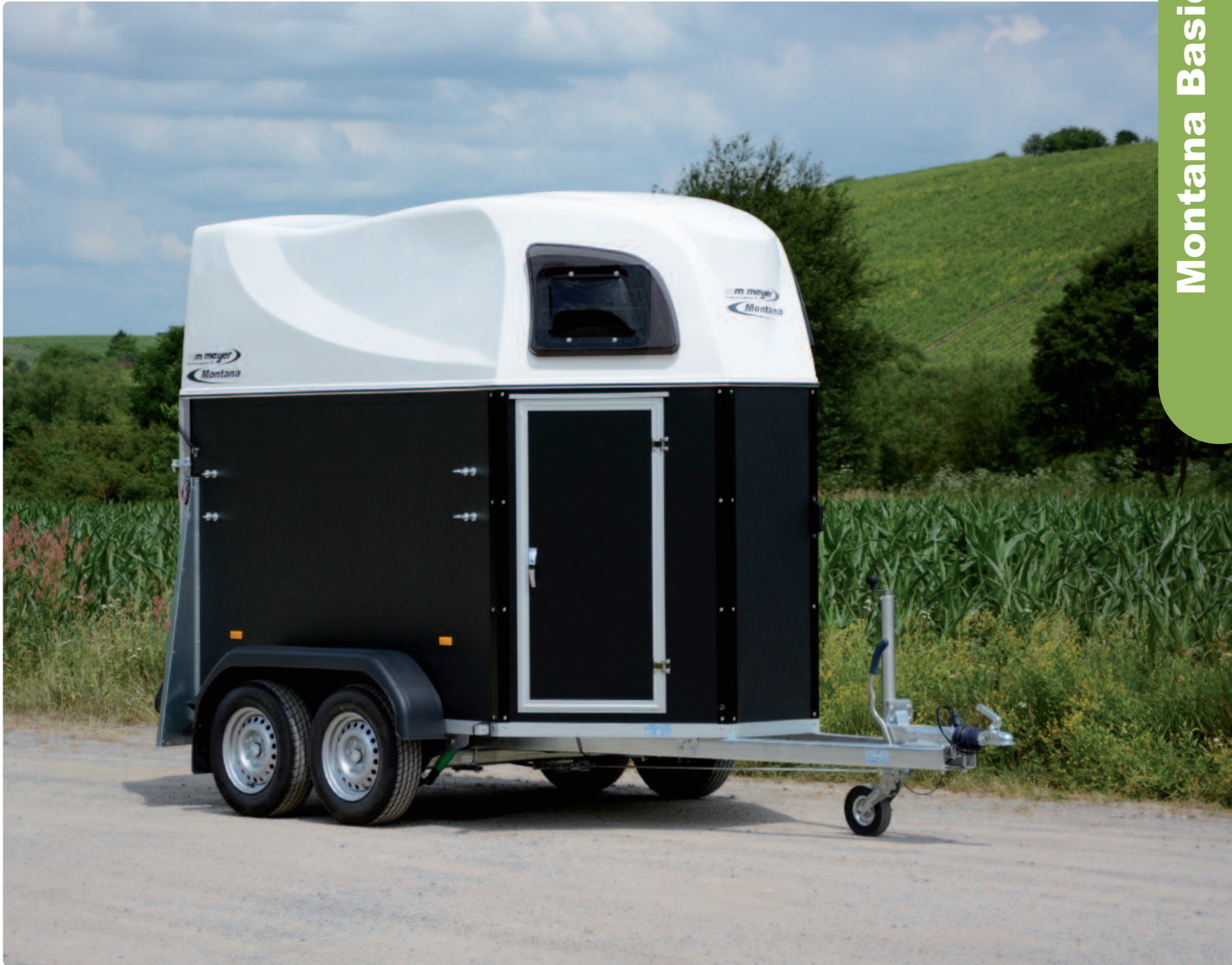
Stützrad verstärkt (klappbar, mittig), Holzwände (schwarz), Servicetür, Polyesterhaube (weiß) Roue jockey renforcée (automatique, au milieu du timon), panneaux en bois (noir), porte de service, hardtop en polyester (blanc) Reinforced jockey wheel (automatic, in the middle of the drawbar), wooden side panels (black), access door, polyester hardtop (white)
