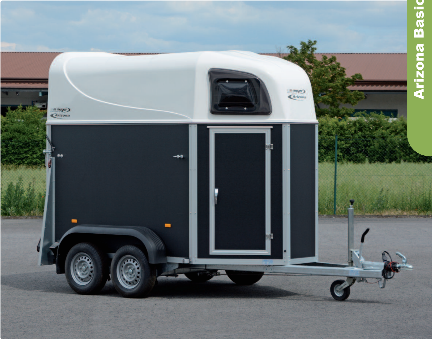
Stützrad verstärkt (klappbar, mittig), kunststoffbeschichtete Holzwände (außen: schwarz, innen: weiß), Polyesterhaube (weiß) Roue jockey renforcée (autom., au milieu du timon), panneaux en bois recouverts de plastique (extérieur : noir, intérieur : blanc), hardtop en polyester (blanc) Reinforced jockey wheel (autom., in the middle of the drawbar), wooden side panels with protective layers (exterior: black, int. white), polyester hardtop (white)
