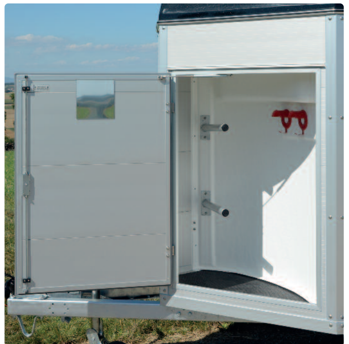
Option: Sattelkammer Groß, Sattelhalter Standard für Dressursättel Opt. : Grande sellerie, supports de selle Standard pour selles de dressage Opt.: Grand saddle chamber, Standard saddle racks for dressage saddles
