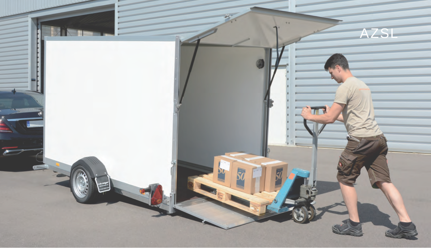
AZSL 1730/176 Senklifttieflader Leichtes Beladen auch mit Hubwagen möglich AZSL 1730/176 Fourgon abaissants roues extérieures Facile à charger aussi avec un chariot élévateur AZSL 1730/176 Elevating lowrider Easy loading with the help of a pallet truck
