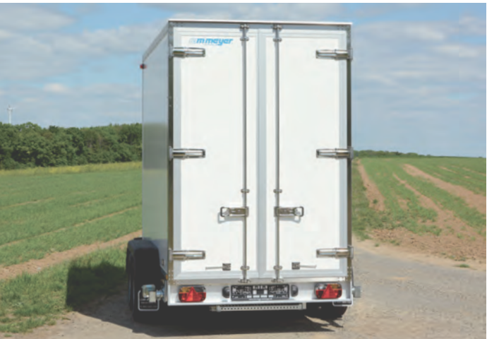
AZK 2730/156 60/60 K Edelstahlcharniere / -beschläge, Z.: Trittstufe ausziehbar AZK 2730/156 60/60 K Charnières / serrures inox, opt. : marchepied extractible AZK 2730/156 60/60 K Stainless-steel hinges / espagnolettes, opt.: pull-out step
