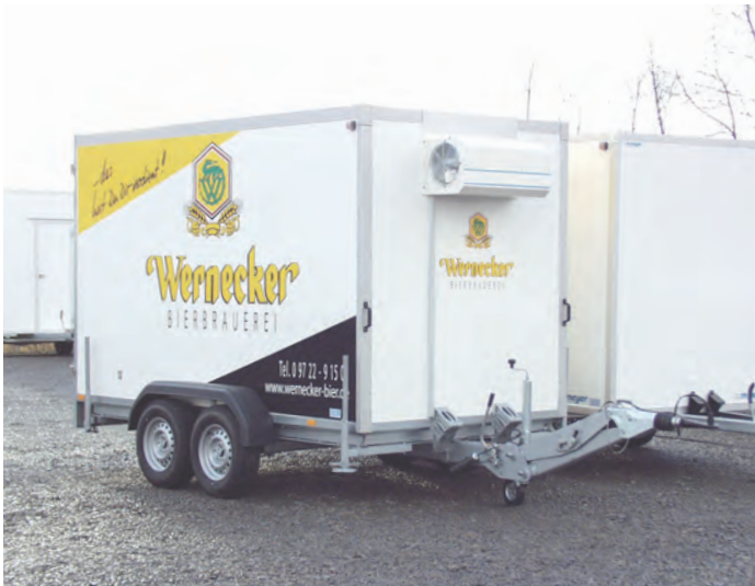
AZKF 2735/180 Sonderkühlung, Zubehör: Deichsel höhenverstellbar AZKF 2735/180 Groupe froid spécial, option : timon réglable en hauteur AZKF 2735/180 Non-standard cooler unit, option: drawbar adjustable in height
