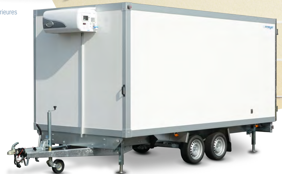
AZKHLC 3044/203 Hochlader, Kühlmaschine WMK 7G; Zubehör: Klappkurbelstützen AZKHLC 3044/203 Fourgons plateau, groupe froid WMK 7G; options : béquille à relever avec manivelle AZKHLC 3044/203 Highrider, cooler unit WMK 7G; optional extras: prop stand to be folded away
