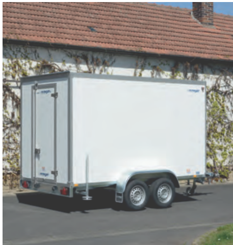
Schwerlaststützen, Sonder: kleine Tür (1 Flügel) Béquilles renforcées, option : petite porte (1 battant) Reinforced prop stands, optional: small door (1 wing)
