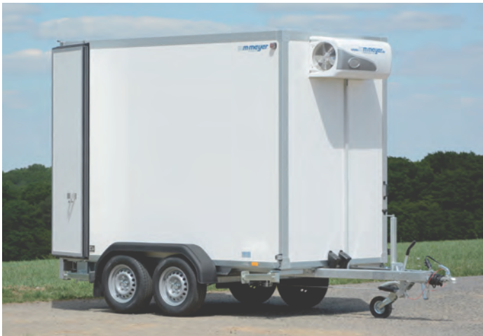
AZK 2730/156 60/60 K Klappkurbelstützen, Zubehör.: Kühlmaschine WMK 4G AZK 2730/156 60/60 K Béquilles à relever, option : groupe froid WMK 4G AZK 2730/156 60/60 K Prop stands to be folded away, opt.: cooler unit WMK 4G
