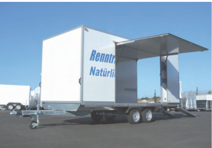
AZHLC 2750/210 Sonder Zubehör: Verkaufsklappe, Werbebeklebung AZHLC 2750/210 Spéciale Options : clapet de vente, publicité AZHLC 2750/210 Special Options: vending hatch, advertising stickers
