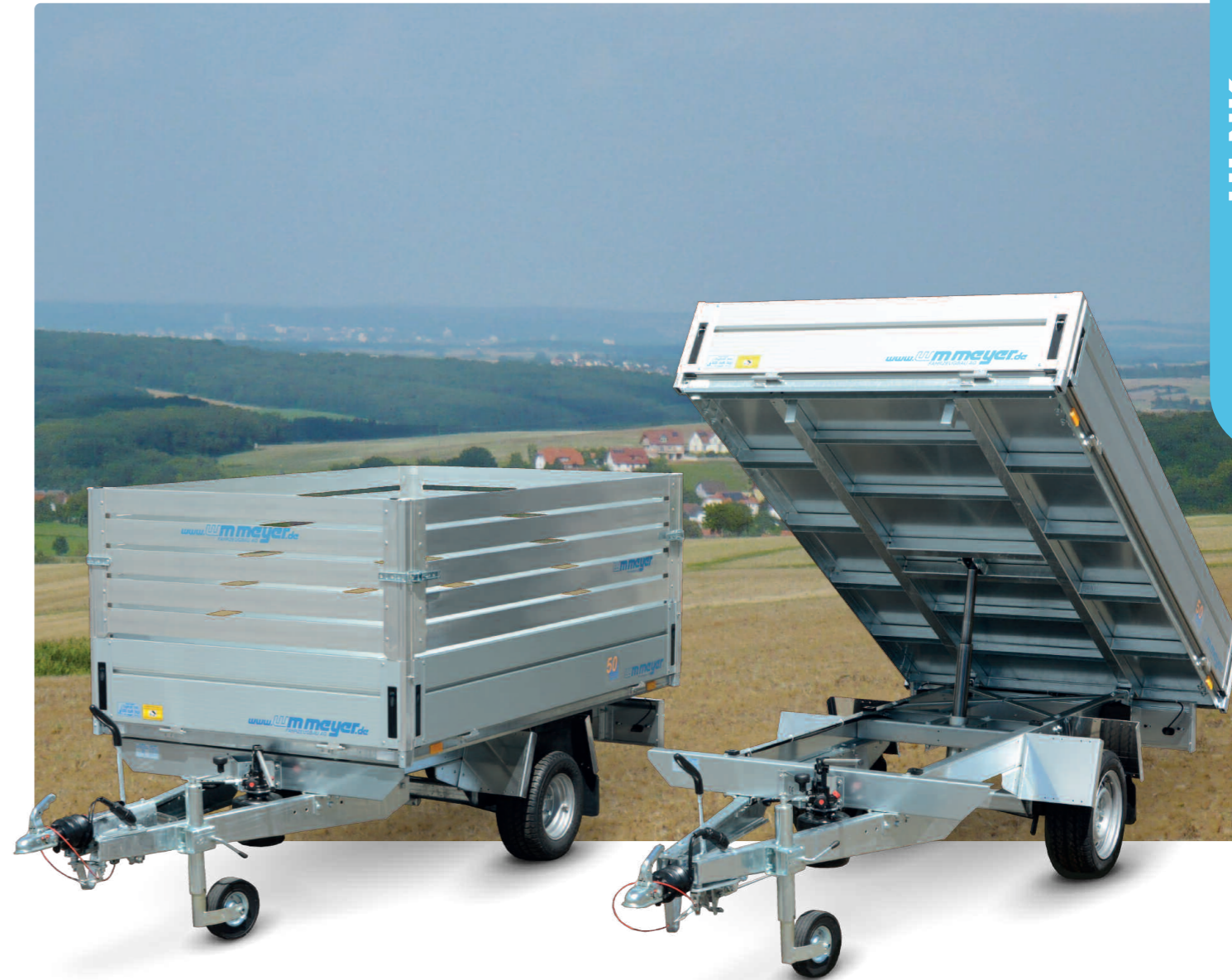
HLNK 1523/141 10"-Bereifung; Zubehör: Alulaubaufsatz • HLNK 1527/151 13"-Bereifung, geschraubtes Chassis, geschweißte Brücke HLNK 1523/141 Pneus 10" ; option : rehausse en alu • HLNK 1527/151 Pneus 13", châssis boulonné, plateau soudé massif HLNK 1523/141 10" wheels; optional extra: aluminium extension sides • HLNK 1527/151 13" wheels, bolted chassis, welded tipping bridge
