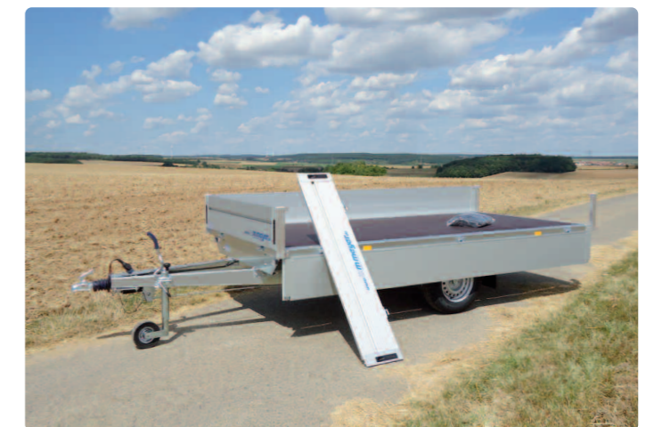
Alle Bordwände abnehmbar, Zubehör: Ladungssicherungsnetz (verpackt) Toutes les ridelles peuvent être enlevées, option : filet d'arrimage (emballé) All side panels can be removed, optional extra: trailer net (in packaging)
