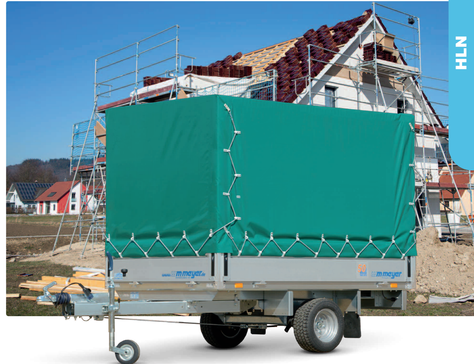
HLN 1323/141 Geschraubtes Chassis; Zubehör: Plane und Aluminiumspiegel HLN 1323/141 Châssis boulonné ; options : bâche et ossature en alu HLN 1323/141 Bolted chassis; optional extra: canvas top, aluminium support
