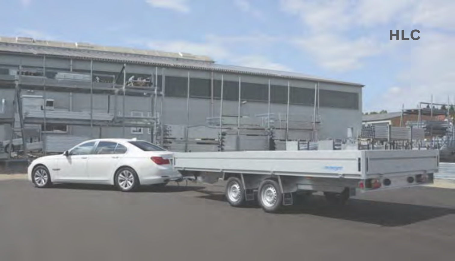
HLC 2751/210 Aluminiumbordwände eloxiert, 4 Seiten klapp- und aushängbar, leichte Be- und Entladbarkeit von drei Seiten HLC 2751/210 Ridelles en aluminium anodisé, ridelles ouvrables et amovibles, facile à charger et décharger des trois côtés HLC 2751/210 Anodised aluminium side panels, all side panels can be opened and removed, easy to load and unload from three sides
