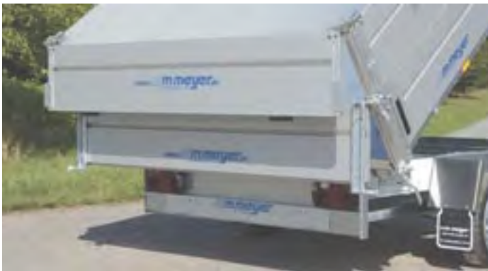
Zubehör: Alubordwanderhöhung abnehmbar; untere Heckwand links: aufgeklappt; untere Heckwand rechts: aufgeschwenkt (bei HKC und HKCR) Option : ridelles supplémentaires en aluminium amovibles ; illustration des 2 manières d'ouvrir la ridelle arrière basse (HKC et HKCR) Optional extra: additional aluminium side panels which can be taken off; illustration of the 2 ways of opening the lower rear panel (HKC and HKCR)
