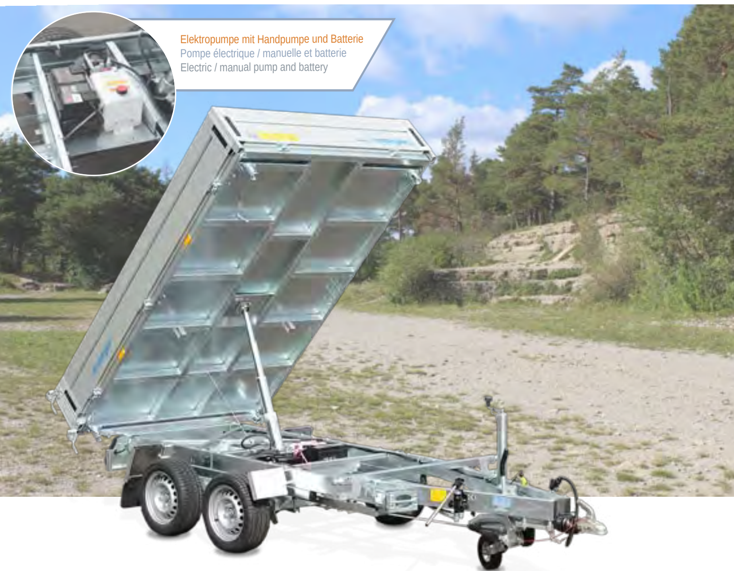
HKD 3527/170 Stützrad verstärkt, V-Deichselrahmen Chassis geschweißt, Kippbrücke geschweißt, Elektropumpe serienmäßig (mit Nothandpumpe) HKD 3527/170 Roue jockey renforcée, châssis en V soudé, pont soudé, pompe électrique de série (avec pompe manuelle d'urgence) HKD 3527/170 Reinforced jockey wheel, V-welded chassis, welded tipping bridge, electric pump (with manual emergency pump) included
