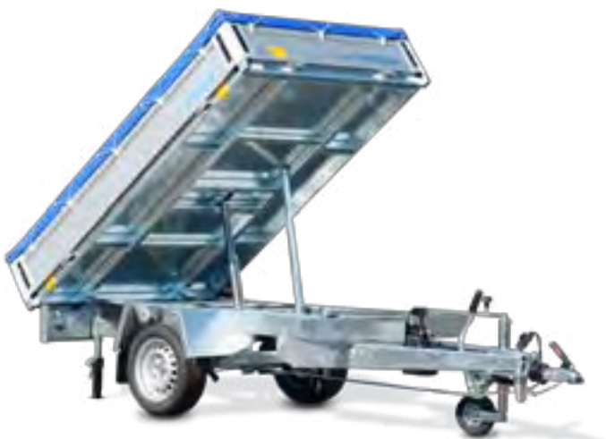
HLNK 1523/141 13" Zubehör: Automatikstützen, Kipperstütze und Flachplane HLNK 1523/141 13" Option : béquilles automatiques HLNK 1523/141 13" Optional extra: automatic prop stands
