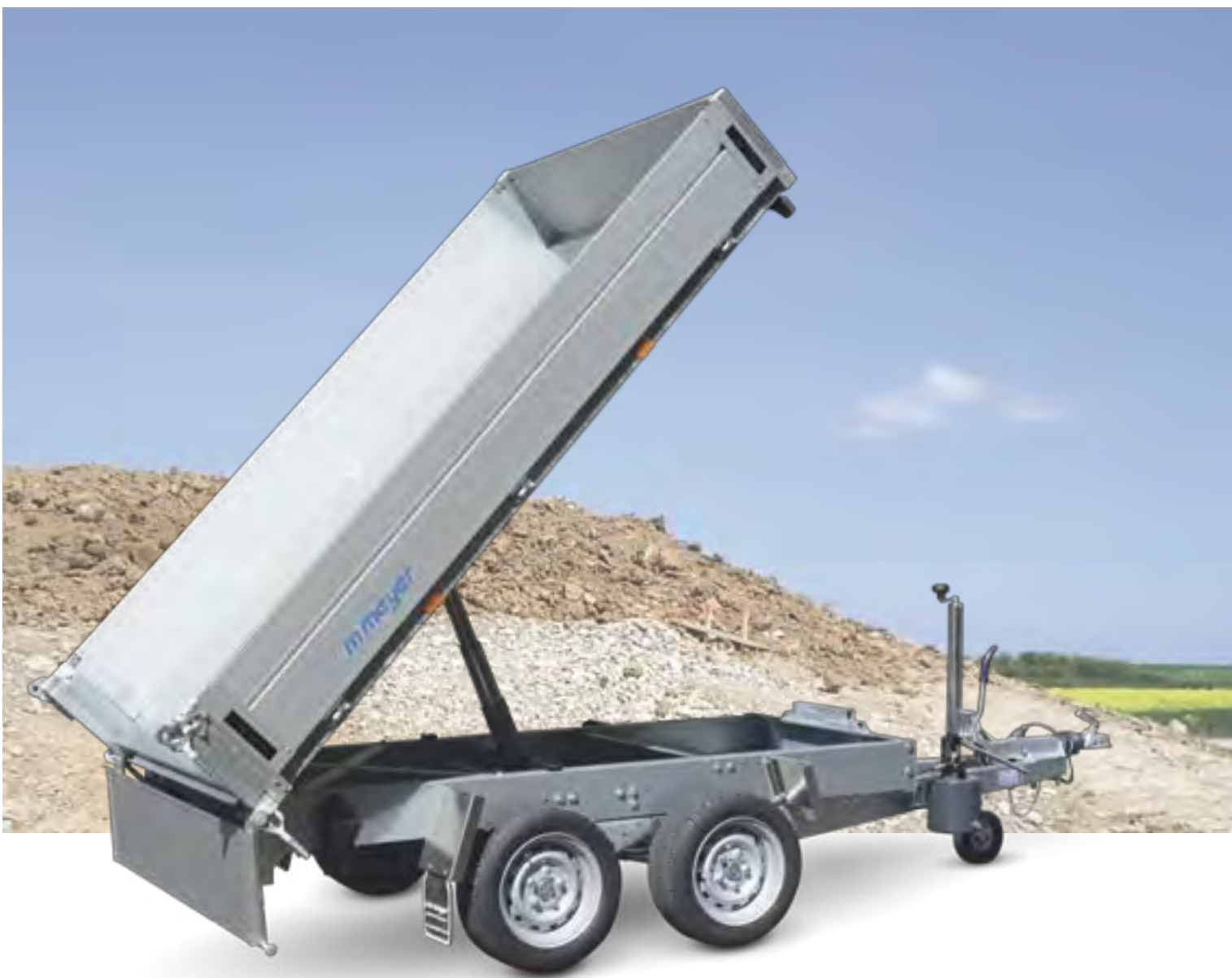
HKCR 2027/155 13"-Bereifung, Chassis, Achsen und V-Deichsel verzinkt, Hydraulikhandpumpe, geschraubtes Chassis, Kippbrücke geschweißt, Metallboden HKCR 2027/155 Pneus 13", châssis, essieux et timon en V galvanisés, pompe hydraulique manuelle, châssis boulonné, pont soudé, plancher en métal HKCR 2027/155 13" tyres, galvanised chassis, axles and V drawbar, manual hydraulic pump, bolted chassis, welded tipping bridge, metal platform
