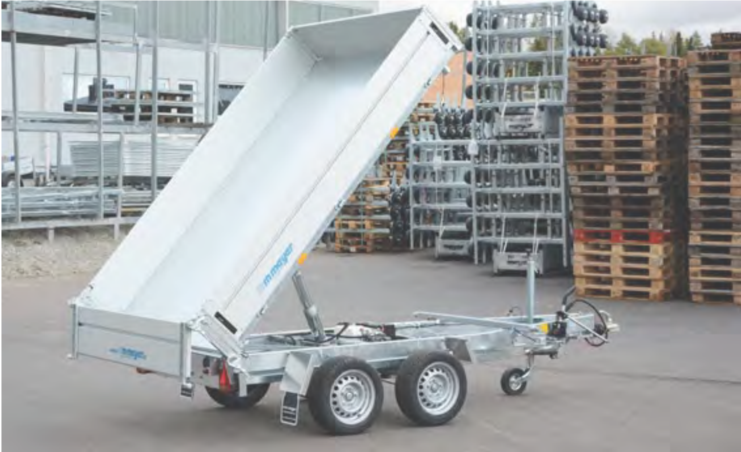
HKD 3527/170 Heckwand pendelbar, Elektropumpe mit Nothandpumpe und Batterie (Ladeeinrichtung vorhanden) HKD 3527/170 Ridelle arrière oscillante, pompe électrique avec pompe manuelle d'urgence et batterie (prise pour chargeur montée) HKD 3527/170 Oscillating rear panel, electric pump with manual emergency pump, battery and charging plug
