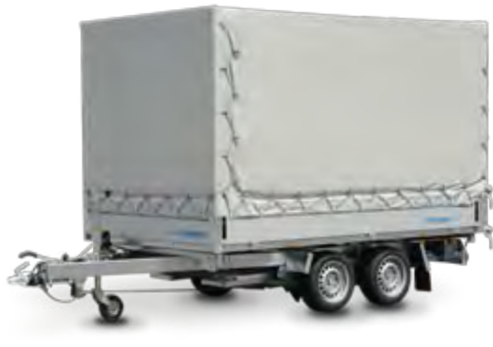
HKD 3031/186 Zubehör: Plane und Aluspriegel (grau, RAL 7044) HKD 3031/186 Option : bâche et supports en aluminium (gris, RAL 7044) HKD 3031/186 Option: canvas top and aluminium support (grey, RAL 7044)
