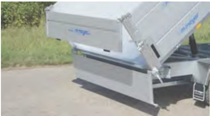
Zubehör: Alubordwanderhöhung abnehmbar; untere Heckwand links: aufgeklappt; untere Heckwand rechts: aufgeschwenkt (bei HKC und HKCR) Option : ridelles supplémentaires en aluminium amovibles ; illustration des 2 manières d'ouvrir la ridelle arrière basse (HKC et HKCR) Optional extra: additional aluminium side panels which can be taken off; illustration of the 2 ways of opening the lower rear panel (HKC and HKCR)
