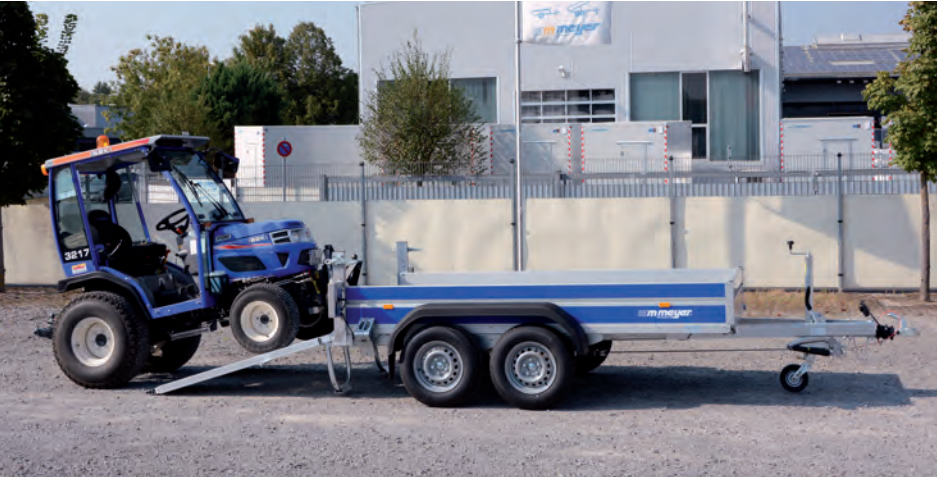
MB 3030/151 Stützrad verstärkt, klappbar, mittig, Dekorbeklebung in Ultramarinblau (ähnlich RAL 5002) MB 3030/151 Roue jockey renforcée, automatique, montée au milieu, décor bleu outremer (~ RAL 5002) MB 3030/151 Reinforced jockey wheel, automatic, decor stickers in ultramarine blue (similar to RAL 5002)
