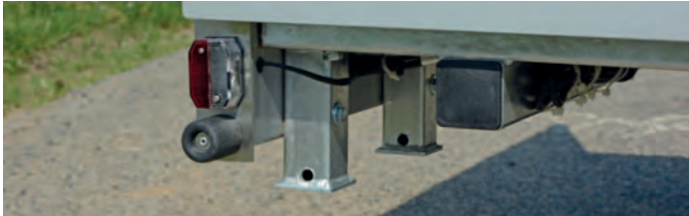
4 Spannverschlüsse außen (rechts / links, Bild oben: vorne, unten: hinten) 4 fermet. à genouillères ext. (gauche / droite, image en haut: avant, en bas : arr.) 4 exterior toggle locks (left / right, picture above: front, picture below: rear) 4 Heckstützfüße zum Schutz des Leuchenträgers beim Kippen 4 pieds d'appui qui protègent la traverse d'éclairage durant le basculement 4 rear struts to protect the rear lights when tipping the trailer
