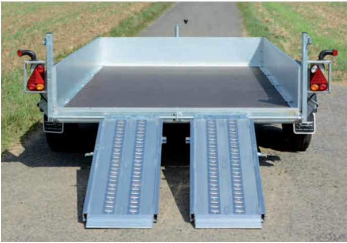
2 verschiebbare Aluminiumauffahrschienen (ca. 1.650 x 440 mm) mit 2 Antirutschauflagen pro Auffahrschiene, gefertigt aus Aluminium mit einfachem Lochbild 2 rampes coulissantes en aluminium (1.650 x 440 mm env.), 2 surfaces anti-glissantes en alu par rampe, 1 rangée de trous par surface 2 sliding aluminium skids (1,650 x 440 mm approx.), 2 non-slip surfaces per skid, made of aluminium, one row of holes
