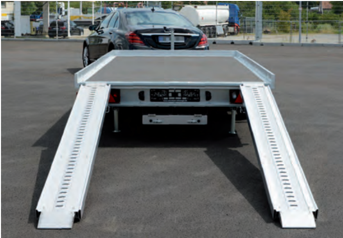
Aluauffahrschienen mit schmaler Antirutschauflage aus verzinktem Stahlblech Rampes en alu avec surface anti-glissante en acier galva, 1 rangée de trous Aluminium skids, standard non-slip surface (galvanised steel), one row of holes
