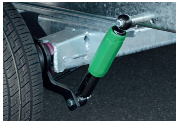
Radstoßdämpfer (Teil der 100-km/h-Ausführung) Amortisseur de roue (fait partie du kit « rouler plus confortablement ») Shock absorber (part of smooth-ride kit)
