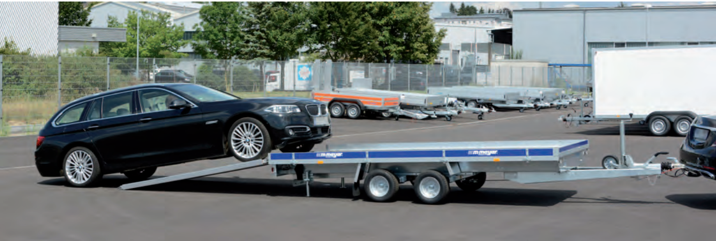
APHLC 2741/210 Zum Beladen Heckstützen nicht ganz bis zum Boden ablassen. Dadurch wird der Auffahrwinkel reduziert – besonders wichtig bei geringer Bodenfreiheit. APHLC 2741/210 Pour charger, ne pas abaisser les béquilles jusqu'au sol. Ainsi, l'inclinaison des rampes est minimisée, important si la garde au sol du véhicule transporté est limitée. APHLC 2741/210 When loading do not lower the prop stands right to the ground. In this way, the approach angle will be reduced – important when the vehicle has limited ground clearance.
