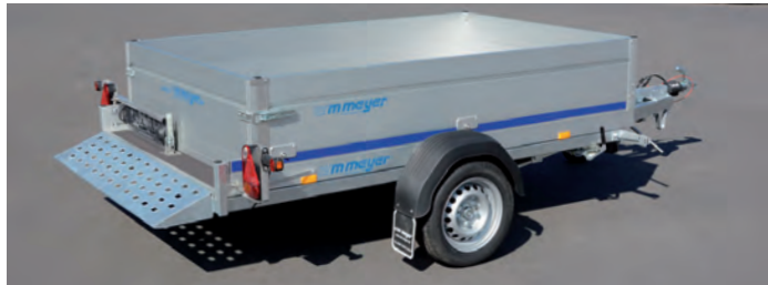
MSL 1530/176 Bordwände mit Dekorbeklebung ultramarinblau (ähnlich RAL 5002), Nummernschildhalter leicht schwenkbar dank Spiralfeder MSL 1530/176 Ridelles avec décor bleu outremer (~ RAL 5002), support de plaque d'immatriculation qui pivote facilement grâce à un ressort spiral MSL 1530/176 Ultramarine blue side panel stickers (similar to RAL 5002), licence plate holder, can be swivelled easily (spiral spring)
