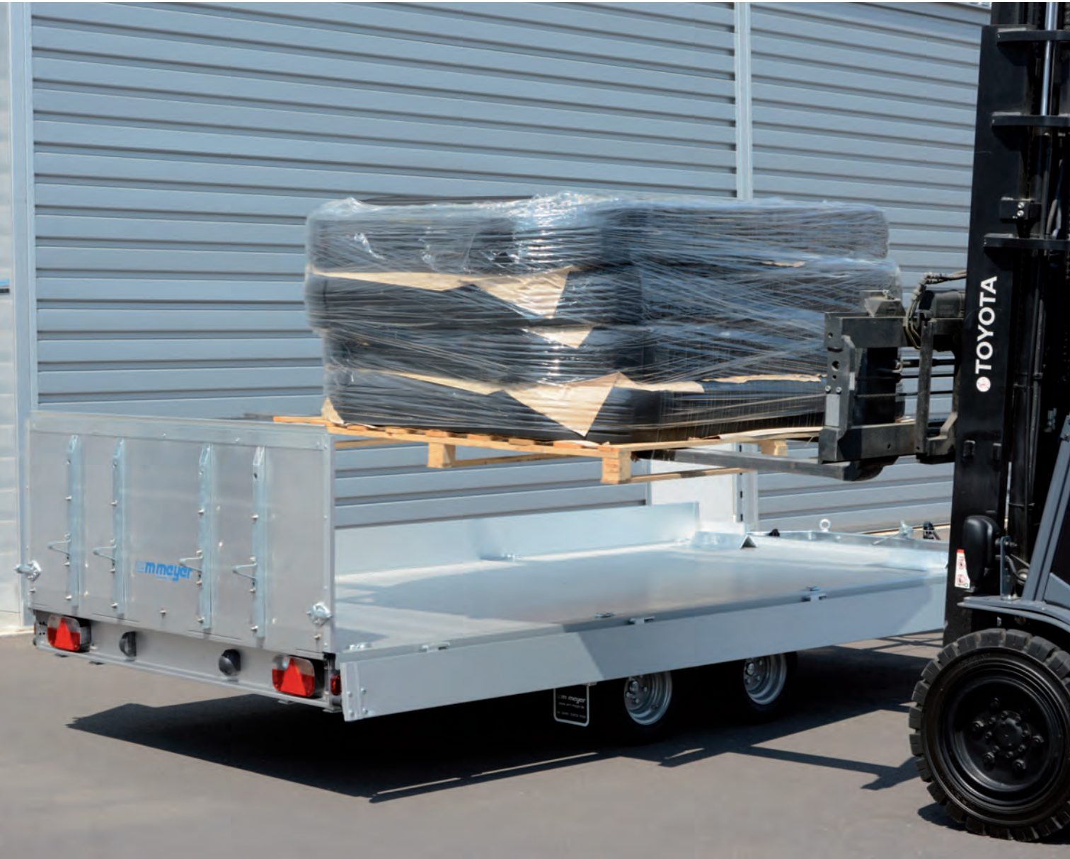
MKHL 3041/202 Aluprofilboden, Aluauffahrrampe (Höhe: ca. 600 mm); Zub.: 2 verstellbare Anfahrkeile MKHL 3041/202 Plancher et pont en alu (hauteur : 600 mm env.) ; options : cales-frein MKHL 3041/202 Aluminium platform / ramp (height: approx. 600 mm) ; options: adjustable wheel supports Unten: 6 Zurringe pro Seite, davon 2 zusätzlich En bas : 6 crochets d'arrimage par côté (4 de série, 2 suppl.) Below: 6 tie rings per side (4 stand., 2 optional)
