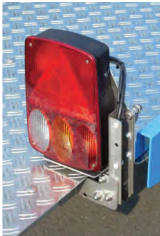
Rückleuchten seitlich montiert (klappbar) Éclairage latéral à l'arrière (rabattable) Rear lights in lateral position (can be folded to the sides)
