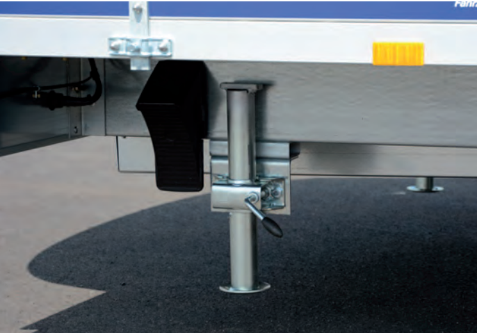
Heckschiebestütze verkürzt, Unterlegkeil Béquille standard raccourcie, cale roue Standard rear prop stand (shortened), wheel chock
