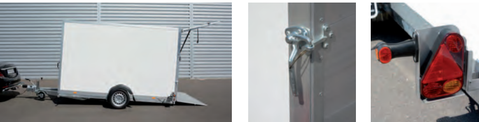
Mitte: Winkelhebelverschluß an Heckrampe Milieu: fermeture avec œillet attachée au pont arr. Middle: angle-lever lock attached to rear ramp
