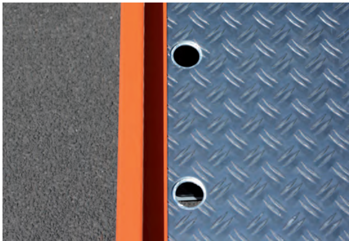
Alustandschienen mit 28-Lochbild für Radsicherung Plateforme ouverte en alu avec 28 trous d'arrimage pour sangles à cliquer Open-centre platform made of aluminium with 28 fastening holes for straps
