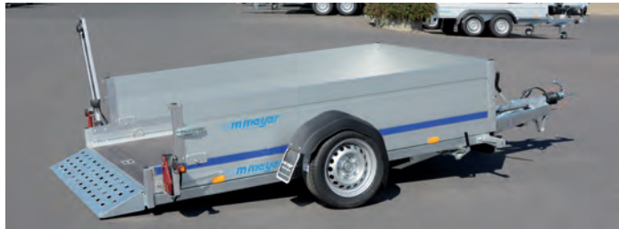
Oben: Zubehör: Bordwanderhöhung, Heckwand arretiert, unten: demontiert En haut : option : ridelles suppl., panneau arrière monté, en bas : démontée Above: option: increased panel height, rear panel fastened, below: taken off
