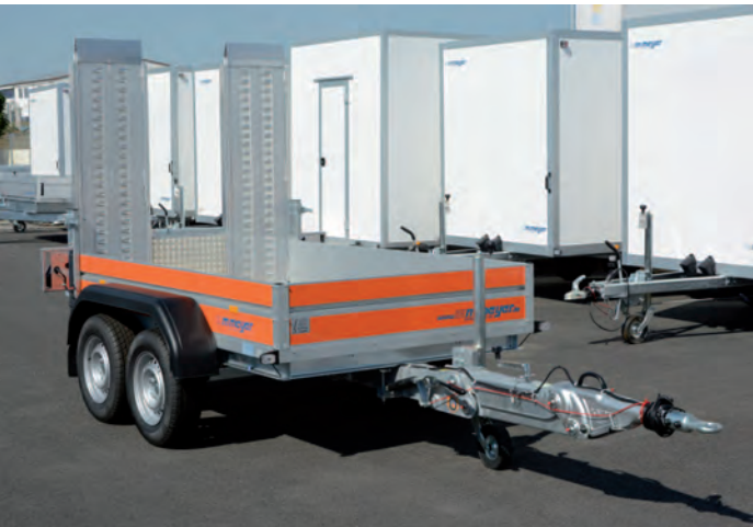
MB 2725/151 Zubehör: Deichsel höhenverstellbar (mit verstärktem Rahmen) MB 2725/151 Option : timon réglable en hauteur (avec châssis renforcé) MB 2725/151 Optional: drawbar adjustable in height (with reinforced chassis)
