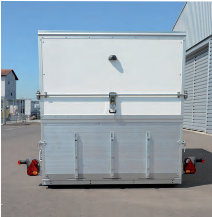
AZSL 1730/176 Geschweißter Rahmen verzinkt, Heckrampe aus Aluminiumprofilen (Tragkraft: ca. 900 kg, Stärke: ca. 21 mm) AZSL 1730/176 Bâti arrière galvanisé, pont arrière en profilés aluminium (PTAC : 900 kg env., épaisseur : 21 mm env.) AZSL 1730/176 Welded, galvanised rear frame, rear ramp made of aluminium profiles (carrying capacity: approx. 900 kg, thickness: approx. 21 mm)
