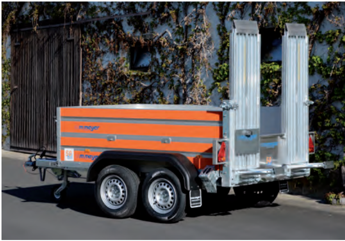
MB 3025/151 Zubehör: Alubordwanderhöhung (Höhe: ca. 350 mm) MB 3025/151 Option : ridelles supplémentaires en alu (hauteur : 350 mm env.) MB 3025/151 Option: additional aluminium side panels (height: approx. 350 mm)
