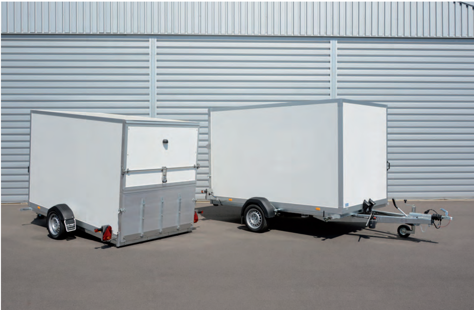
AZSL 1730/151 und AZSL 1730/176 Wände, Heckklappe und Dach aus Sandwichpolyester (Stärke: ca. 25 mm), Hydraulikhandpumpe AZSL 1730/151 et AZSL 1730/176 Panneaux, clapet arrière et toit en polyester sandwich (épaisseur : 25 mm env.), pompe hydraulique manuelle AZSL 1730/151 and AZSL 1730/176 Side panels, rear hatch and roof made of sandwich polyester (thickness: approx. 25 mm), manual hydraulic pump
