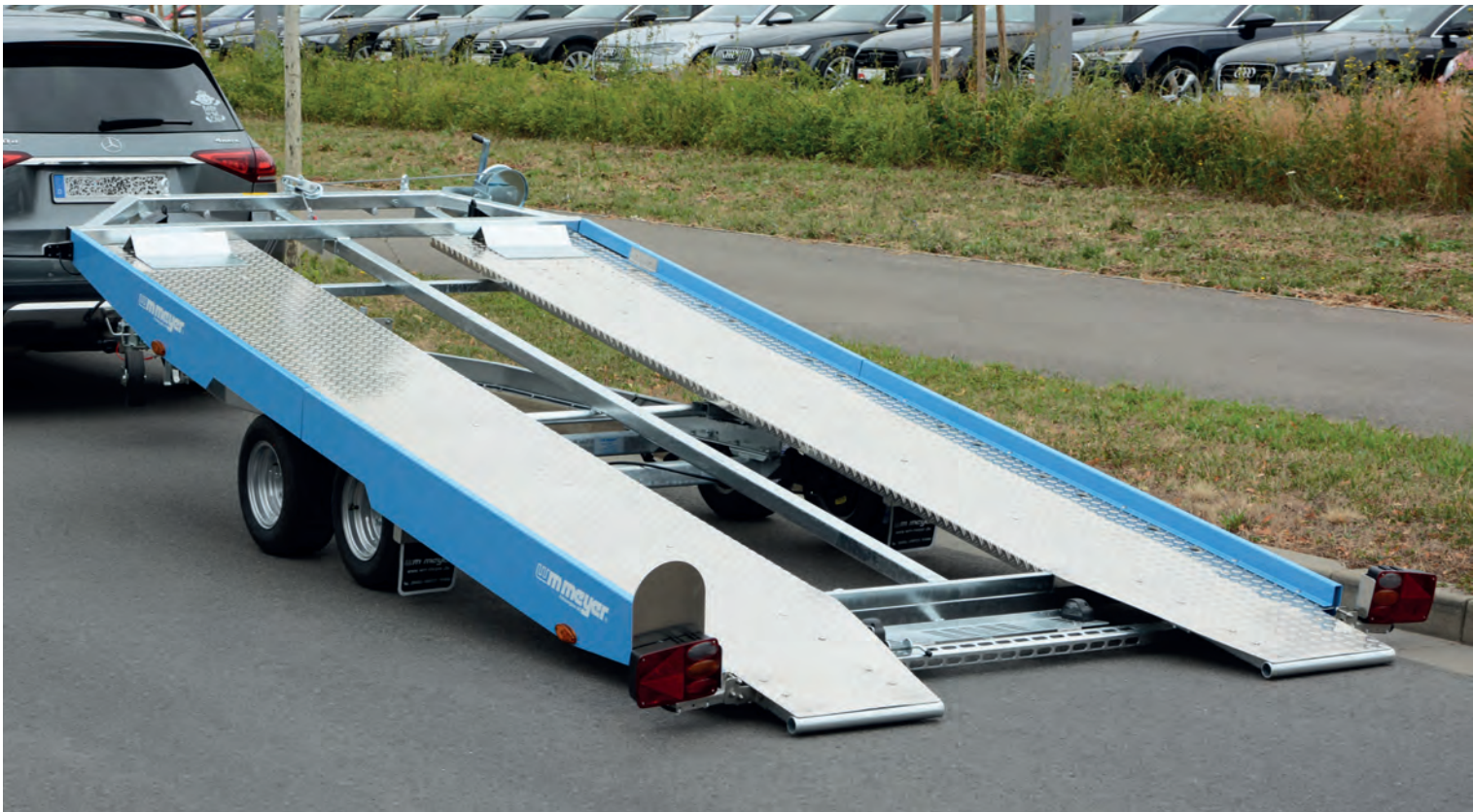
KHL 3000 Racing 100-km/h-Ausführung, Rückleuchten seitlich montiert (klappbar), Nummernschildhalter klappbar, 2 verstellbare Anfahrkeile KHL 3000 Racing Kit « rouler plus confortablement », éclairage latéral à l'arrière (rabattable), support de plaque abaissable, 2 cales-frein (position variable) KHL 3000 Racing Smooth-ride kit, tilt-away licence plate holder, rear lights in lateral position (can be folded to the sides), 2 adjustable wheel supports
