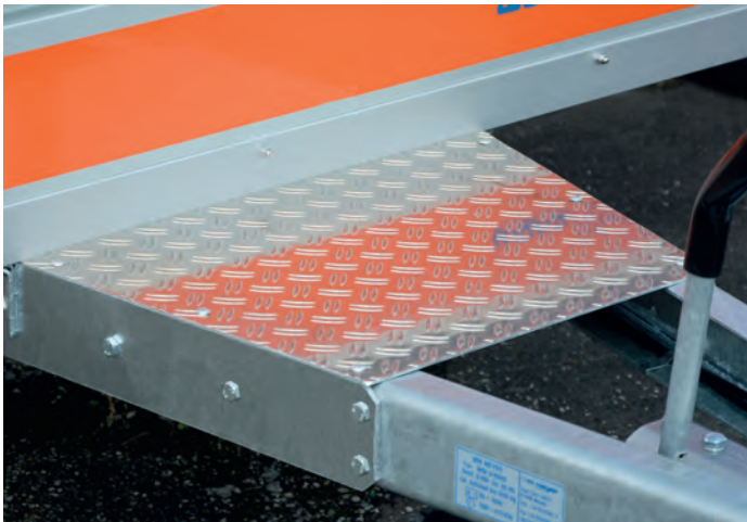
Zubehör: Baggeröffelauflage auf Deichsel (aus Aluriffelblech) Option : support pour le godet d'une mini-pelle monté sur le timon (en alu strié) Optional extra: excavator bucket rest on drawbar (aluminium checker plate)
