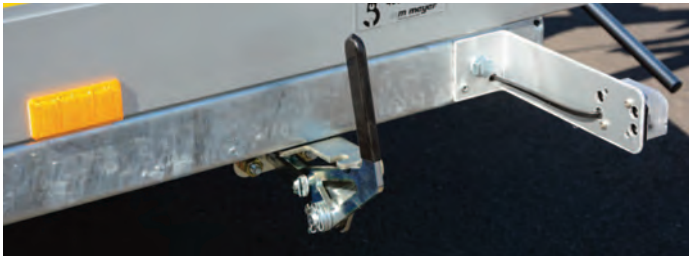
Oben: V2A-Befestigungspunkt im Boden-Wand-Profil, unten: Absenkhebel En haut : point d'arrimage coulissant, en bas : levier d'abaissement Above: stainless-steel tie-down point, below: lowering lever
