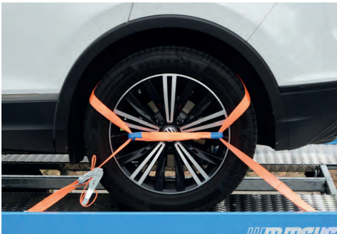
Zubehör (Serie bei KHL Touring / Racing): Radsicherungsgurt Option (de série avec KHL Touring / Racing) : sangle à cliquer Option (standard feature of KHL Touring / Racing): load securing strap
