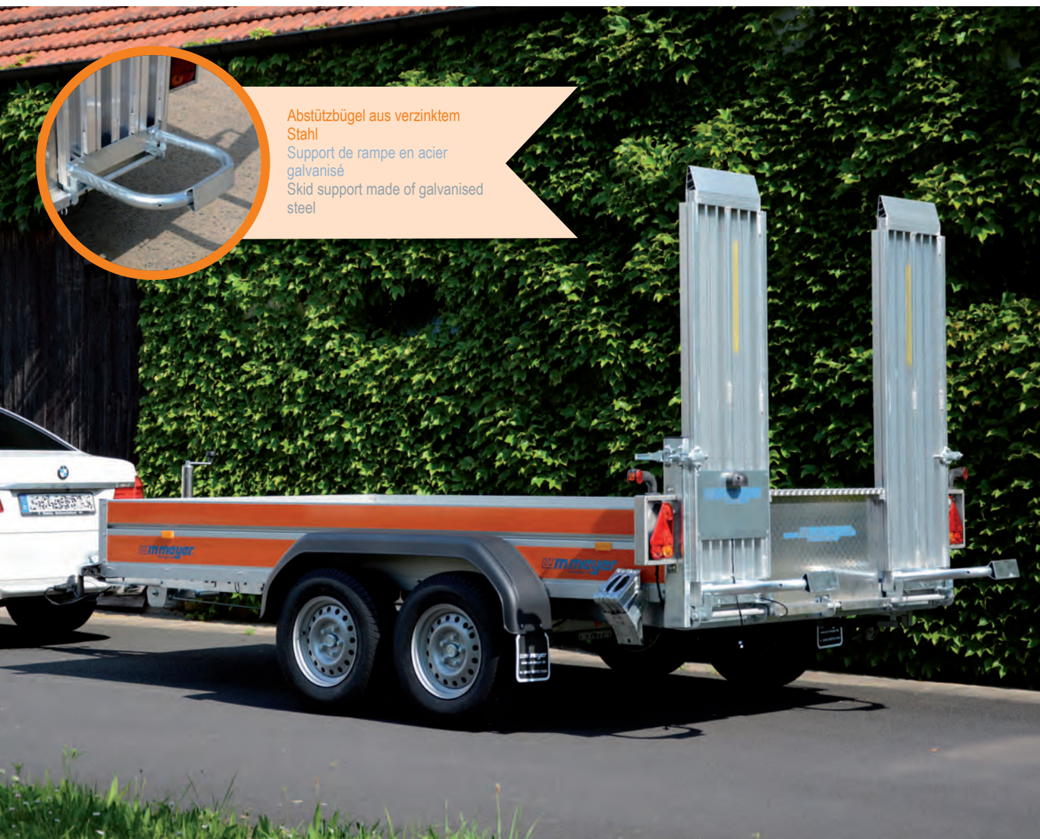
MB 3535/185 Aluminiumbordwände (Stärke: 25 mm, Höhe: 350 mm), 2 Aluminiumauffahrschienen, 2 Abstützbügel aus verzinktem Stahl MB 3535/185 Ridelles en aluminium (épaisseur : 25 mm, hauteur : 350 mm), 2 rampes en aluminium, 2 supports en acier galvanisé MB 3535/185 Aluminium side panels (width: 25 mm, height : 350 mm), 2 aluminium ramps, 2 supports made of galvanised steel
