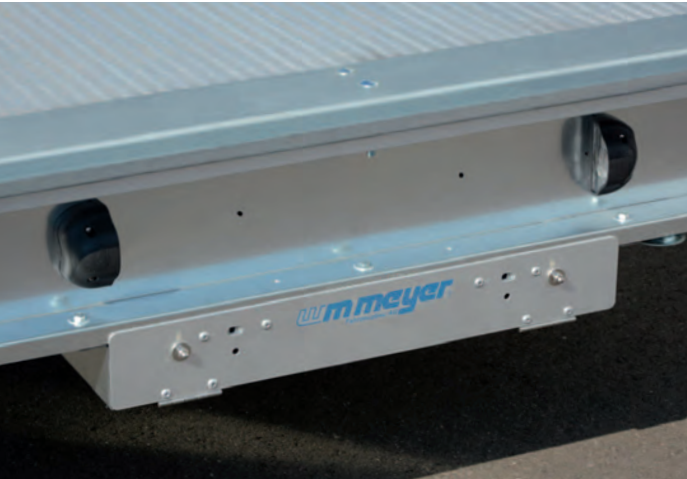
Auffahrschienenenschächte mit Klappe; Zubehör: Aluprofilboden Supports de rampes avec clapet rabattable ; option : plancher en profilés alu Storage shafts for skids with flaps; optional extra: aluminium profile platform
