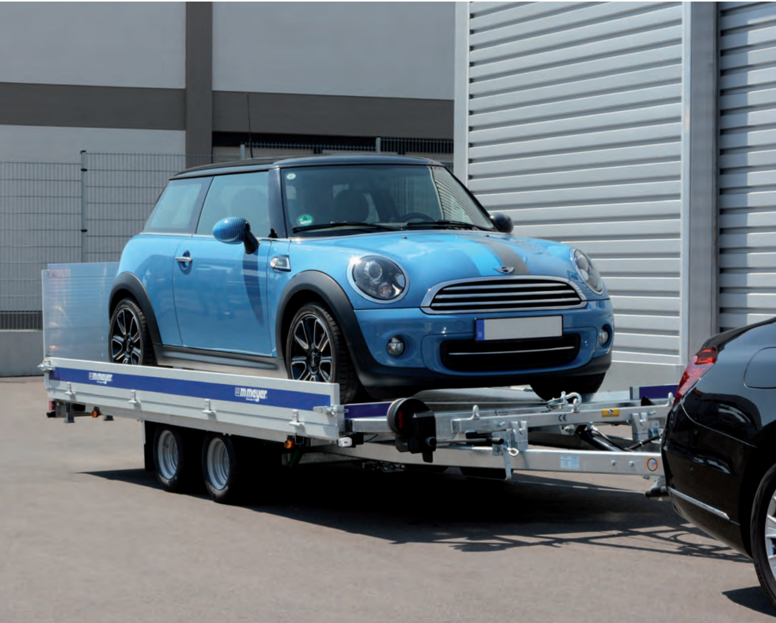
MKHL 3041/202 Bordwand vorne 100 mm hoch, Bordwände seitlich 200 mm hoch und klappbar, Zubehör: Hub- und Zugzylinder, 1-Gang-Winde MKHL 3041/202 Ridelle avant (hauteur : 100 mm), ridelles latérales rabattables (hauteur : 200 mm), options : vérin de poussée et de traction, treuil 1 vitesse MKHL 3041/202 Front panel (height: 100 mm), side panels (height: 200 mm) which can be opened, optional extras: push and pull cylinder, single-speed winch
