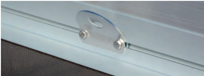
MSL 1530/176 Bordwände mit Dekorbeklebung ultramarinblau (ähnlich RAL 5002), Nummernschildhalter leicht schwenkbar dank Spiralfeder MSL 1530/176 Ridelles avec décor bleu outremer (~ RAL 5002), support de plaque d'immatriculation qui pivote facilement grâce à un ressort spiral MSL 1530/176 Ultramarine blue side panel stickers (similar to RAL 5002), licence plate holder, can be swivelled easily (spiral spring)
