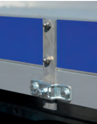
Bordwandhalterung (Schraubsicherung) Support de ridelles latérales (fixé par vis) Side panel support (screw locking)
