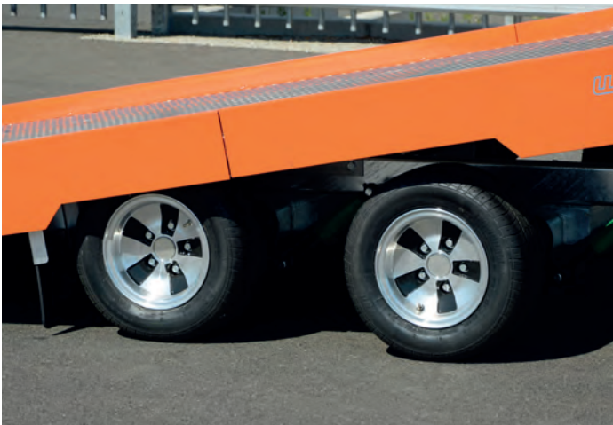
Zubehör: Bereifung 195/55 R10 C mit Alufelgen Option : pneus 195/55 R10 C avec jantes en aluminium Optional extra: 195/55 R10 C tyres with aluminium rims
