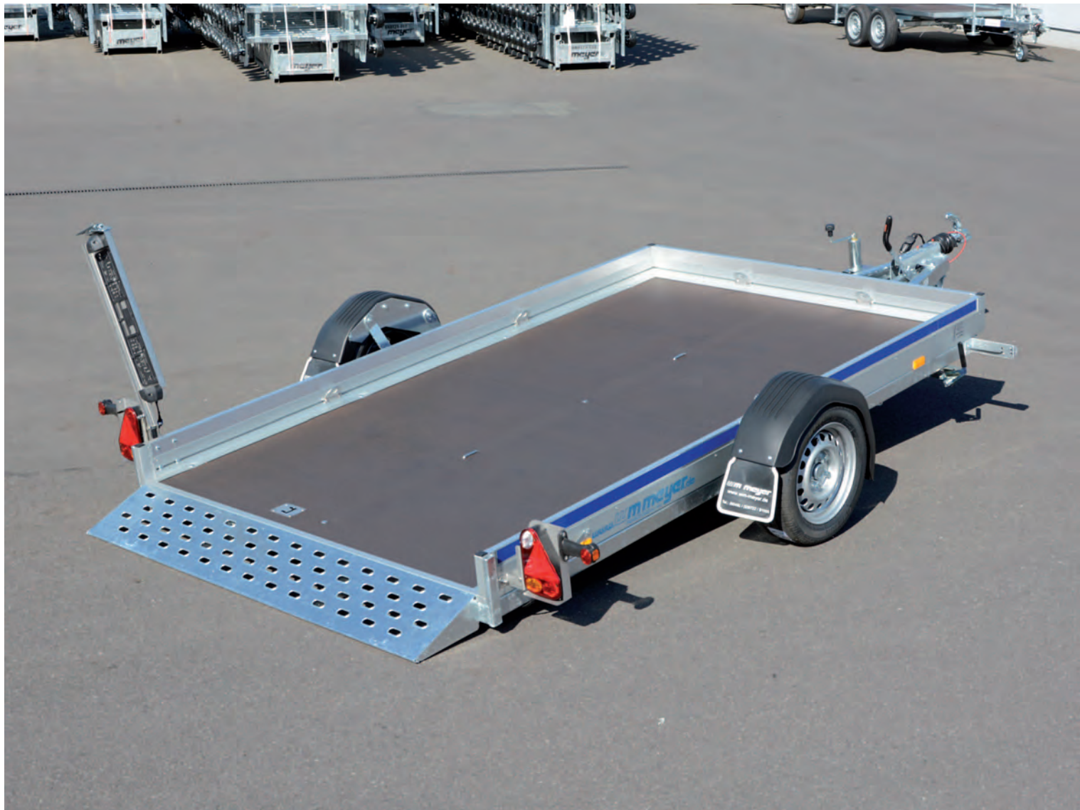
MSL 1530/176 Bordwände mit Dekorbeklebung ultramarinblau (ähnlich RAL 5002), Nummernschildhalter leicht schwenkbar dank Spiralfeder MSL 1530/176 Ridelles avec décor bleu outremer (~ RAL 5002), support de plaque d'immatriculation qui pivote facilement grâce à un ressort spiral MSL 1530/176 Ultramarine blue side panel stickers (similar to RAL 5002), licence plate holder, can be swivelled easily (spiral spring)
